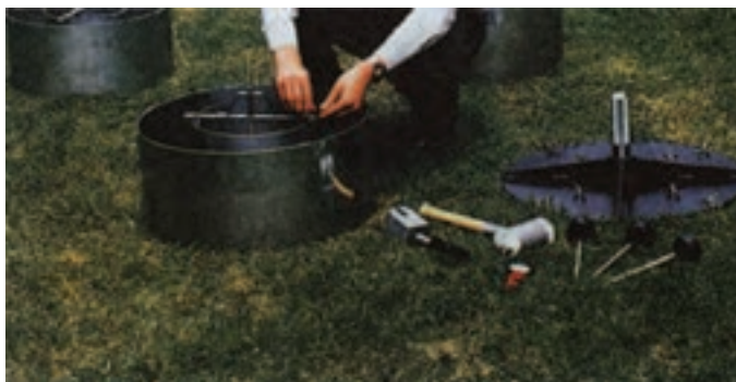
شکل ۱-۸ نحوه کار گذاشتن استوانه مضاعف
