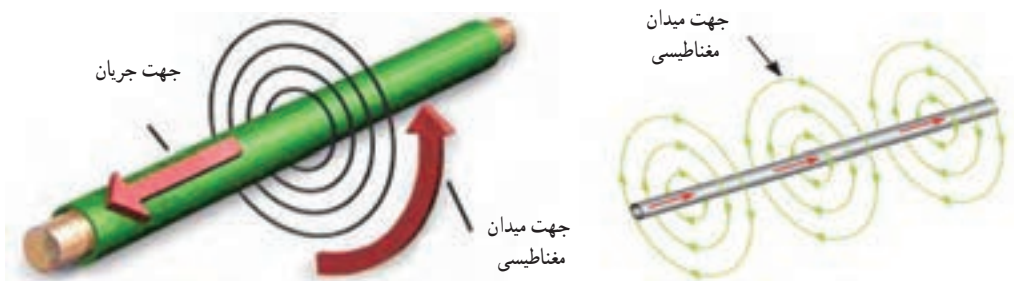
شکل ۴-۴- خاصیت مغناطیسی اطراف سیم حامل جریان
