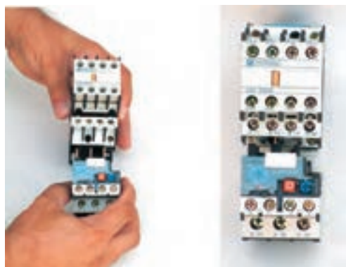
شکل ۵-۴۰- نحوه قرارگیری بی‌متال زیر کنتاکتور
