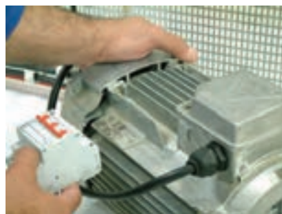
شکل ۸۱-۵- دقت به پلاک موتور هنگام انتخاب فیوز
