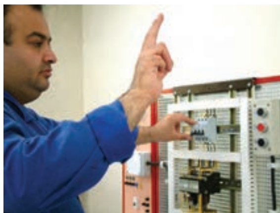
شکل ۶۸-۵- وصل همزمان سه فیوز در مدارات راه‌اندازی موتورهای سه فاز
