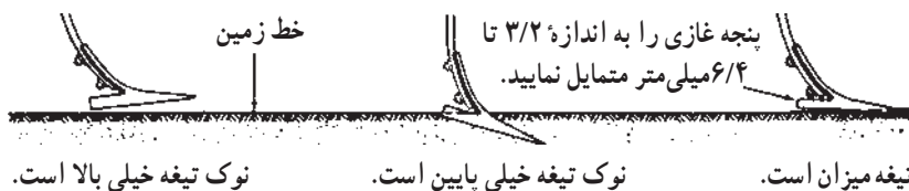
شکل ۷-۱- روش صحیح قرارگرفتن تیغه پنجه‌غازی نسبت به زمین
