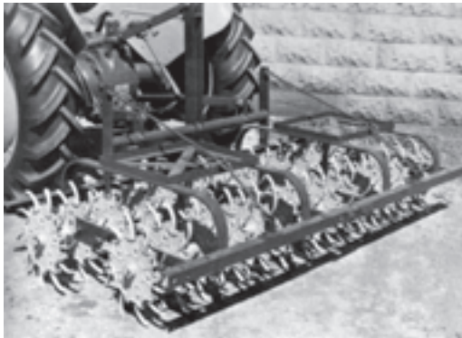
شکل ۱-۹- یک دستگاه کامل پنجه دوار
