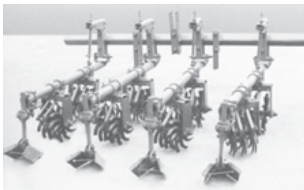
شکل ۱۱-۱- دستگاه پنجه غلتان با شیارکش
