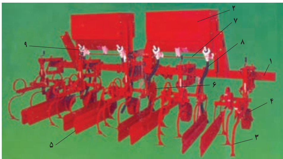
۱- شاسی ۲- صندوق کود ۳- شاخه ۴- چرخ ۵- سپر محافظ ۶- چرخ ستاره ای محرک موزع کودپاشی ۷- محور موزع ها ۸- لوله سقوط کود ۹- موزع
