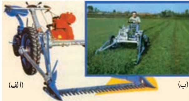
شکل ۱۲- ۴- الف- اجزای دروگر خودگردان، ب- دروگر خودگردان هنگام درو علوفه
