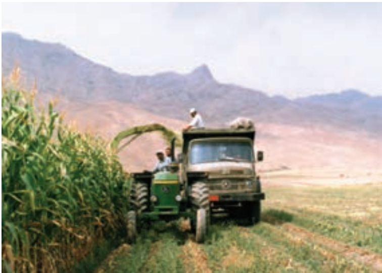
شکل ۷-۱۴- ذرت خردکن حین برداشت ذرت علوفه و تخلیه به داخل کامیون
