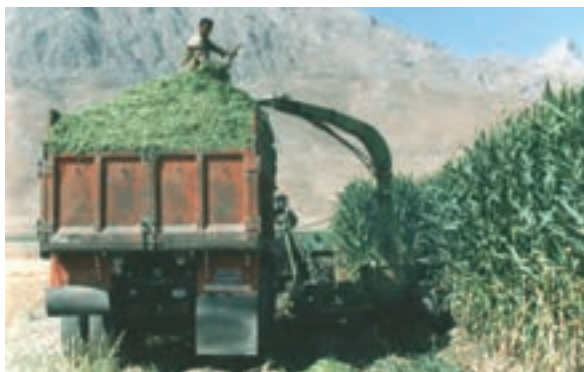
شکل ۱۰-۷ – ذرت خردکن در حال تخلیه مواد برداشت شده به داخل کامیون
