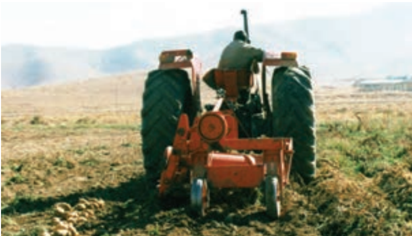
ب - سیب‌زمینی‌کن در حال عملیات برداشت
