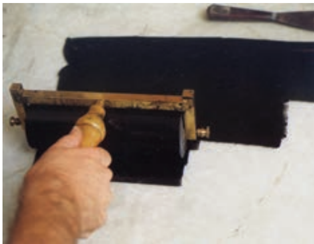
تصویر ۶۰- پخش کردن مرکب روی سطح شیشه
