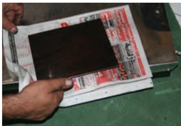
تصویر ۱۸۲- لازم است کلیشه در دو مرحله (قبل از مرکب زدن و پس از پاک کردن مرکب‌های اضافه یعنی درست قبل از چاپ) روی هیتز گذاشته شده و گرم شود.
