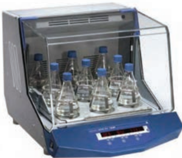
شکل ۹-۱- نمونه‌ای از گرم‌خانه رومیزی مجهز به سیستم تکان دهنده
