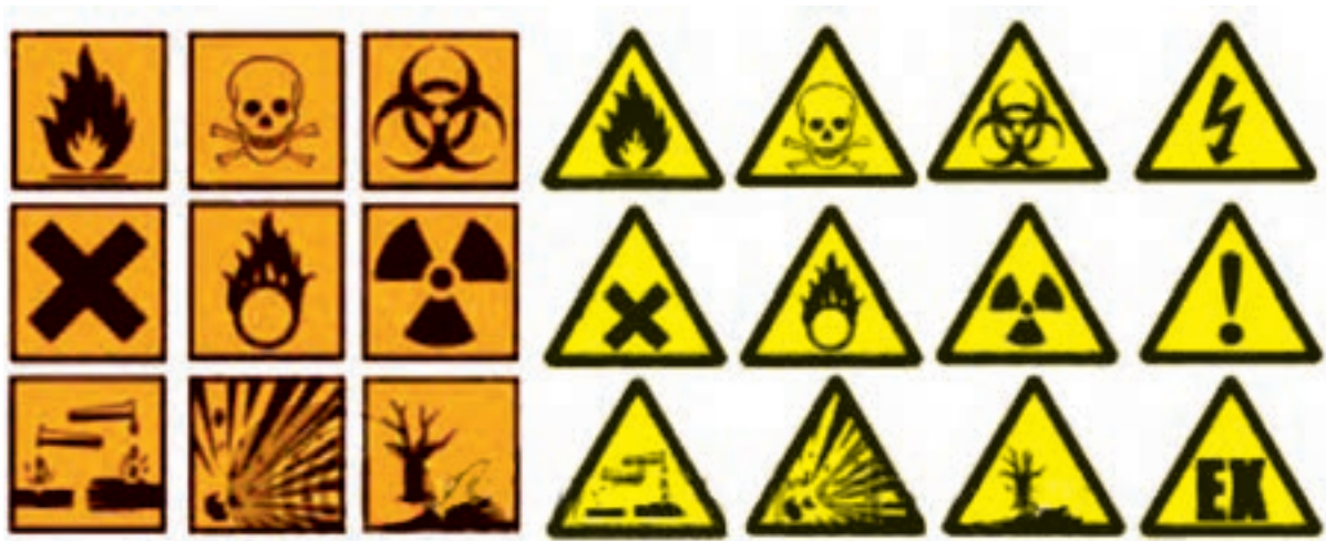
شکل ۵-۱- برخی علائم هشدار دهنده روی برچسب مواد شیمیایی
