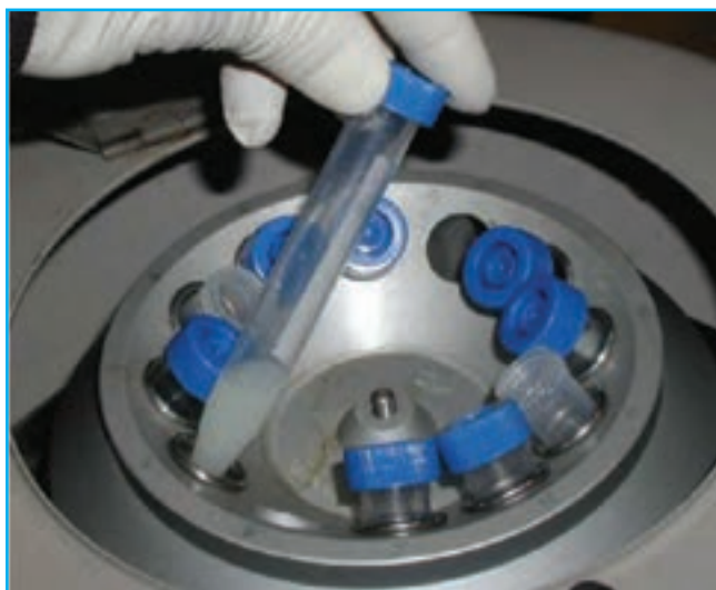
شکل ۱۴-۱- قرار دادن لوله‌های محتوی مواد مورد آزمایش در سانتریفوژ
