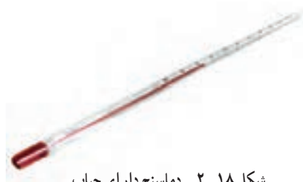
شکل ۱۸-۲- دماسنج دارای حباب مایع دار (دماسنج جیوه‌ای)
