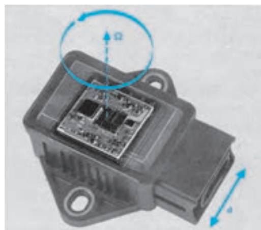
\alpha - جهت دریافت شتاب \Omega - مقدار انحراف زاویه‌ای یابو
