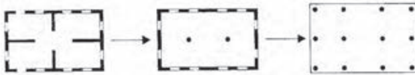
تکامل سازه از دیوار باربر تا ستون‌های باربر - قرن نوزدهم
