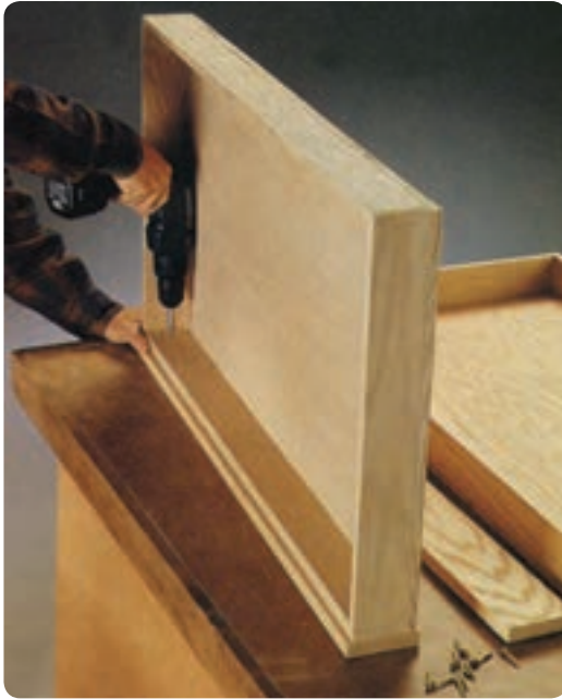
شکل ۱-۴۰ کاربرد تخته سه‌لایه در کف جعبه
