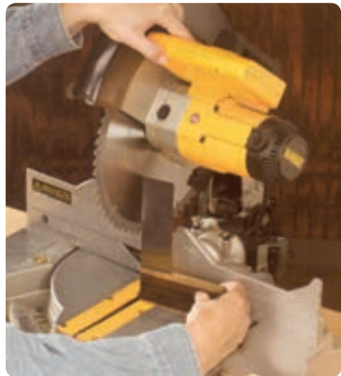
شکل ۲-۷ تنظیم عمود بودن تیغه پشت به صفحه
