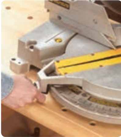
شکل ۲-۸ تنظیم زوایای مختلف برش
