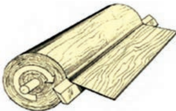
شکل ۱-۲۰ تهیه روکش به روش لوله‌بری
