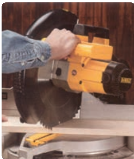
شکل ۲-۵ حرکت اهرمی در اره گرد فارسی بر
