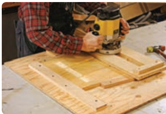
شکل ۳-۲۹ شابلون تسریع‌کننده و حفاظتی اورفرز
