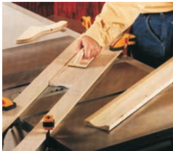
شکل ۳-۱۸ شابلون کمکی برای هدایت قطعه چوب روی اره گرد
