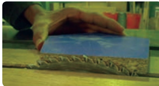
شکل ۳-۳۸ تنظیم ارتفاع تیغه اره
