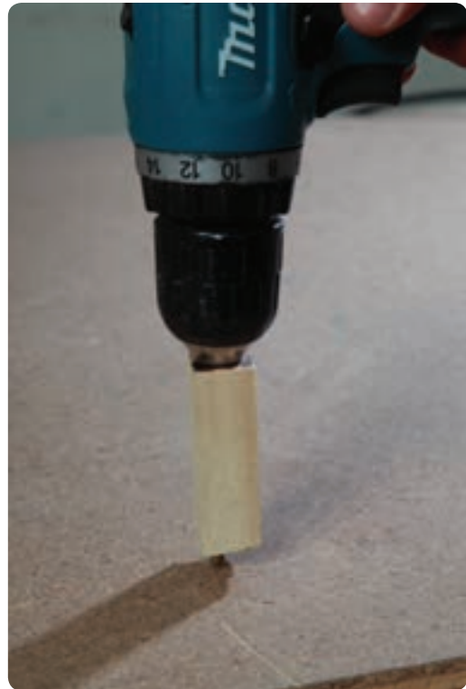
شکل ۳-۳۲ سوراخ دریل قطعه کنترل اندازه عمق
