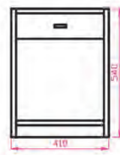
نمای کابینت باتختی بدون در، با جعبه و با پاستنگ (عمق ۳۰۰)
