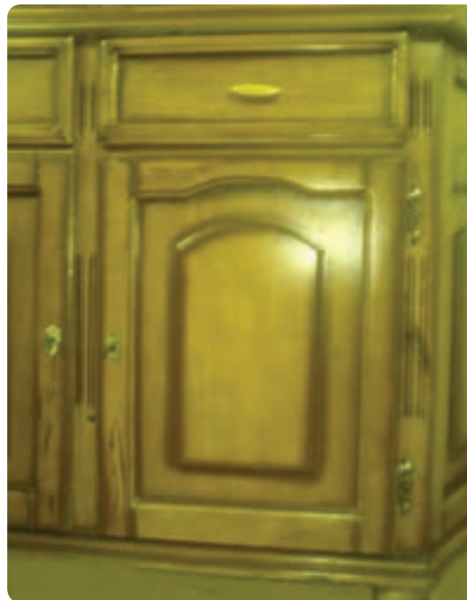
شکل ۶-۲۰ در قاب تنک‌های روئسته دو راه‌دار
