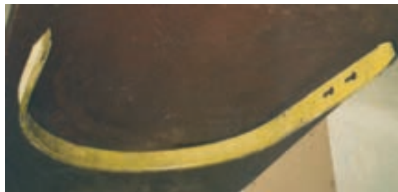
شکل ۳۲-۱- طوقه شکسته و کج شده
