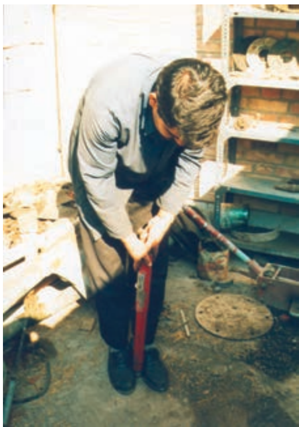
شکل ۳۸-۱- آزمایش کمک فنر
