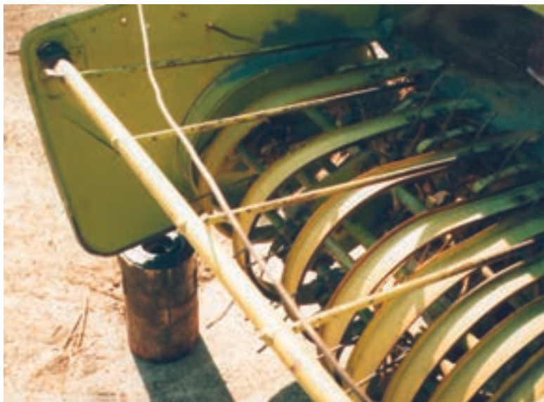
شکل ۱۵-۱- قرار دادن بردارنده روی خرک
