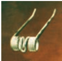
شکل ۱۸-۱- انگشتی کج شده، شکسته و ساییده شده
