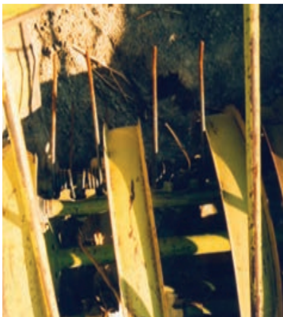
شکل ۲۱-۱- پایه انگشتی شکسته
