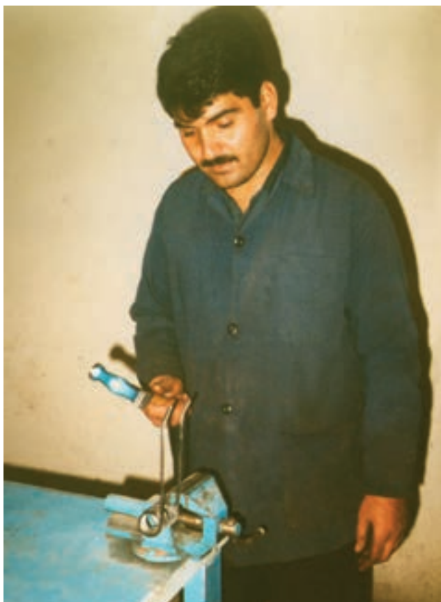
شکل ۲۰-۱- قرار دادن انگشتی‌ها مابین گیره و صاف کردن با چکشی
