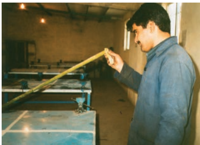
شکل ۲۳-۱- فردی در حال آزمایش کجی محور انگشتی‌ها
