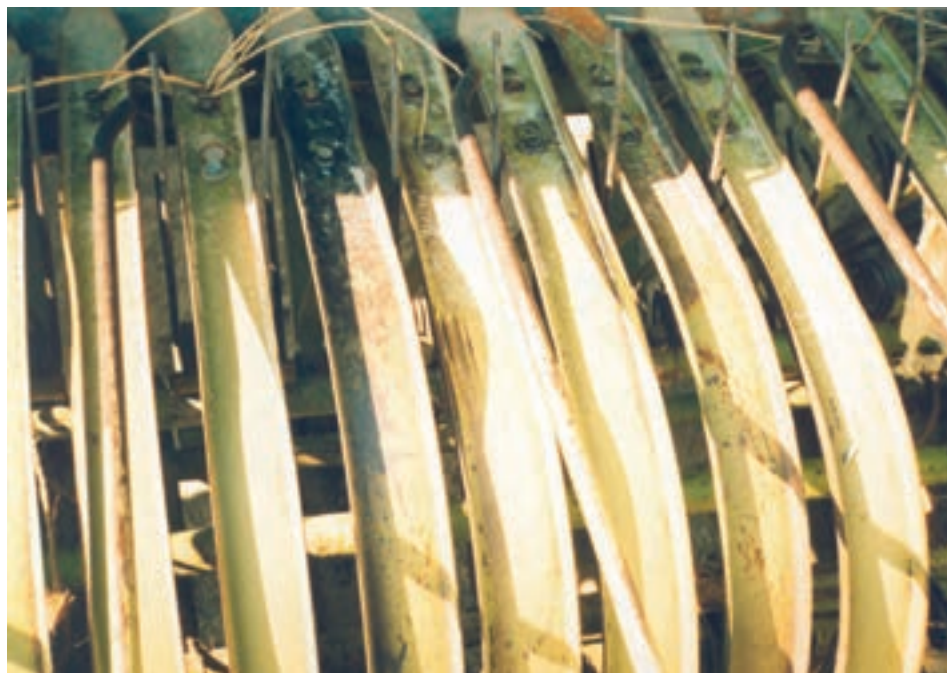
شکل ۱۹-۱- ساییده شدن انگشتی‌ها به طوقه‌ها
