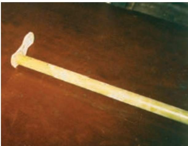
شکل ۲۶-۱- پایه کج شده بلبرینگ انگشتی
