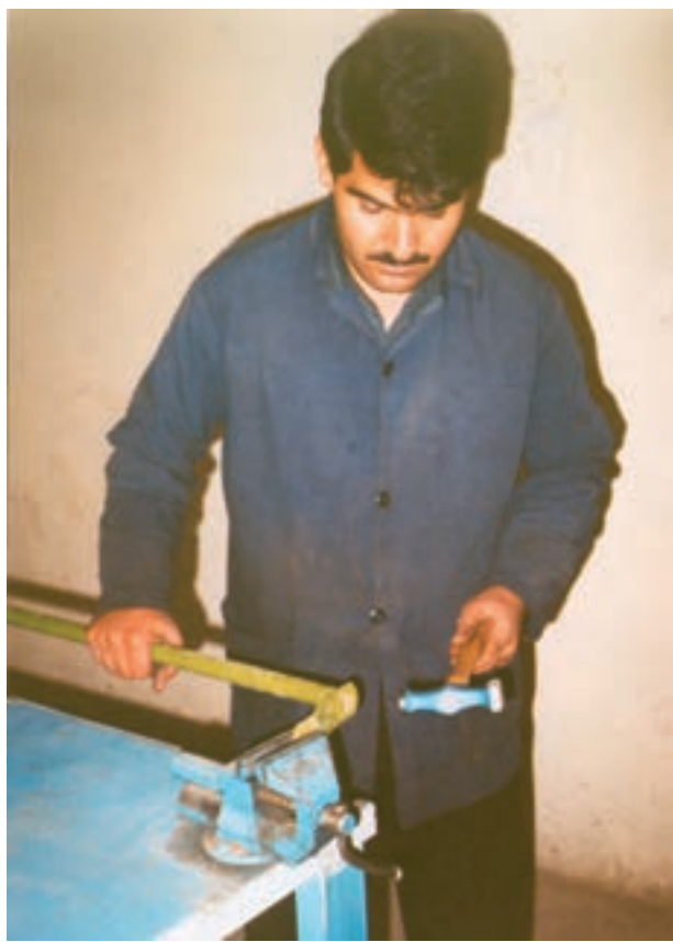
شکل ۲۸-۱- حین صاف کردن پایه بلبرینگ‌ها یا چکشی
