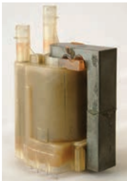
شکل ۱-۱۳۳- شکل ظاهری ترانسفورماتور TR526
