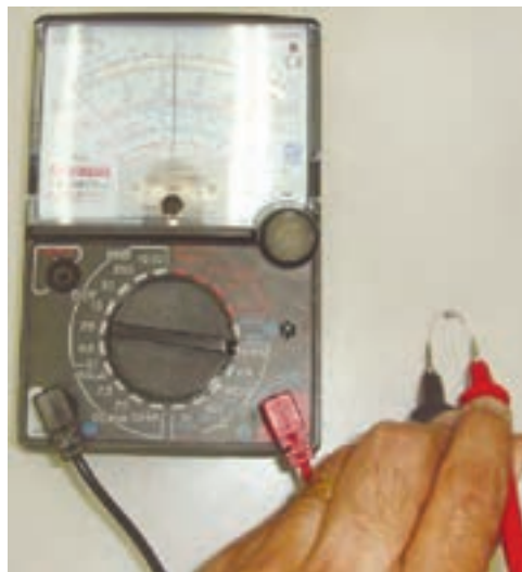
شکل ۱۶-۱- تست دیود با اهم‌متر عقربه‌ای
