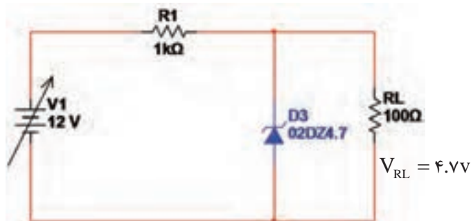
شکل ۴۹-۱- مدار رگولاتور ولتاژ با دیود زنر
