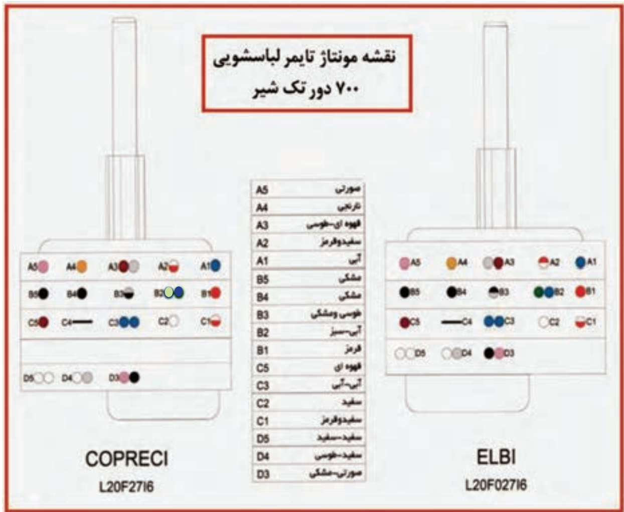
شکل ۱-۱۶۵- نقشه مونتاژ تایمر لباسشویی ۷۰۰ دور تک شیر
