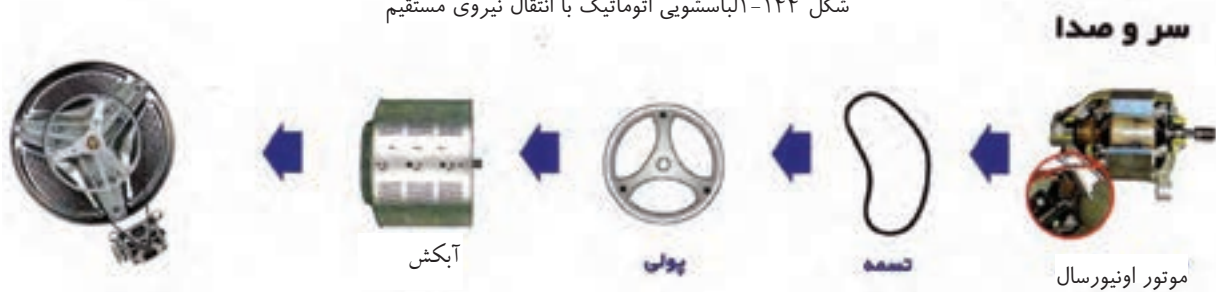
شکل ۱-۱۴۵-الباسشویی اتوماتیک با انتقال نیروی غیرمستقیم
