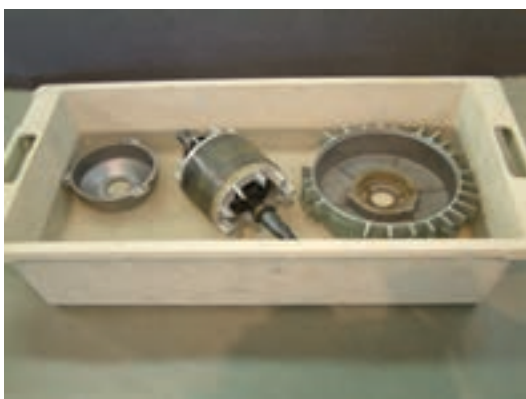
شکل ۱-۳۲ - شست‌وشوی قطعات با آب گرم
