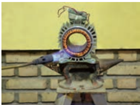
شکل ۲-۱۸- سوزاندن مستقیم سیم‌ها با شعله
