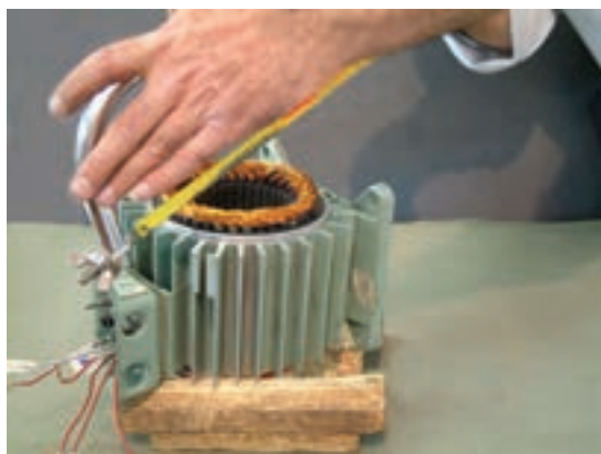
شکل ۱۶-۲- برش پیچک‌ها و شمارش تعداد دور
