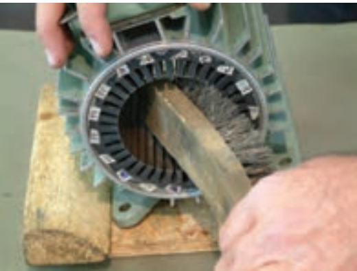
ب – تمیز کردن استاتور با برس سیمی
