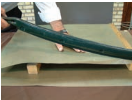
شکل ۲۹-۲ - کاتر یا دستگاه برش‌دهنده‌ی عایق‌های برشمان
