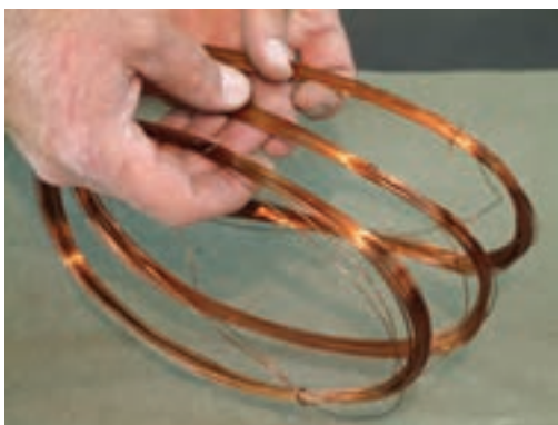
شکل ۱۹-۳- درآوردن کلاف از قالب
