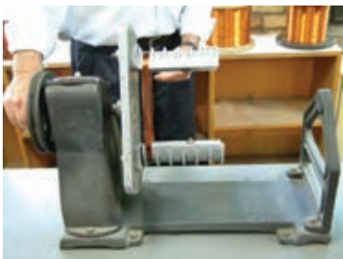
شکل ۱۷-۳- پیچیدن سیم‌ها روی قالب‌ها
