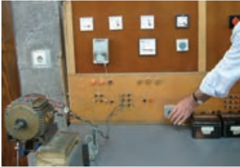
شکل ۹-۶- اتصال موتور به تابلوی برق
