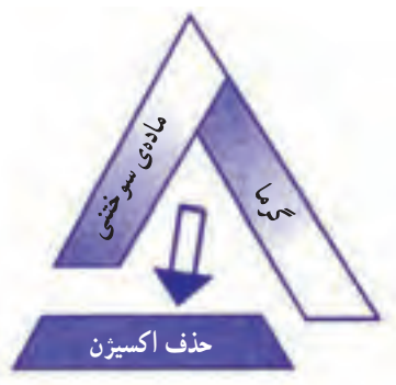
شکل ۱۶-۱- ممانعت از رسیدن اکسیژن به ماده‌ی سوختنی
