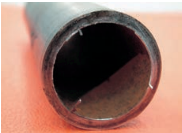
الف - لوله‌ی بریده شده به وسیله‌ی لوله‌بُر
