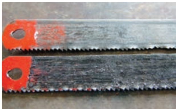
شکل ۱-۴۷- تیغه اره‌های دندان‌شکسته شده
