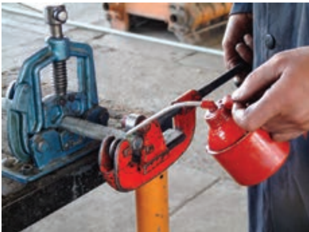
شکل ۱-۵۷- ریختن روغن در محل تماس
