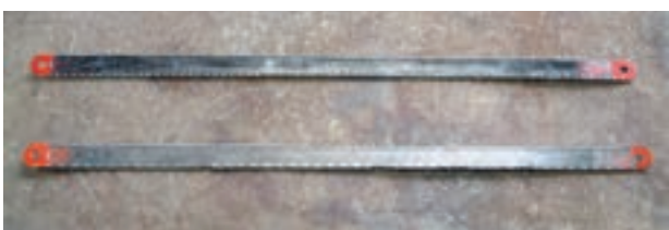
شکل ۱-۴۰ - از بین رفتن دندان‌های تیغه اژه
