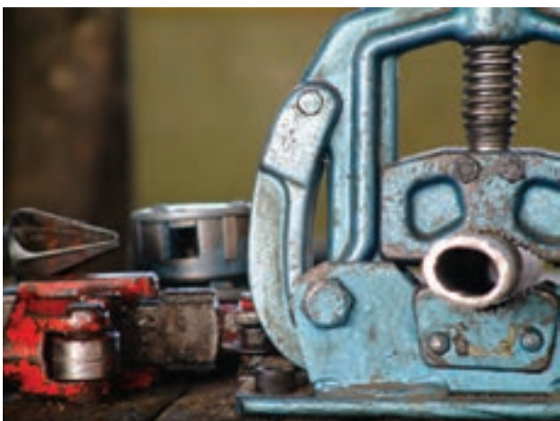
شکل ۲-۱۶- لوله‌ی دو پهن شده
