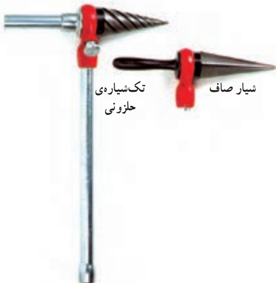
شکل ۲-۵- بُرقو با لبه‌های بُرنده‌ی مختلف
