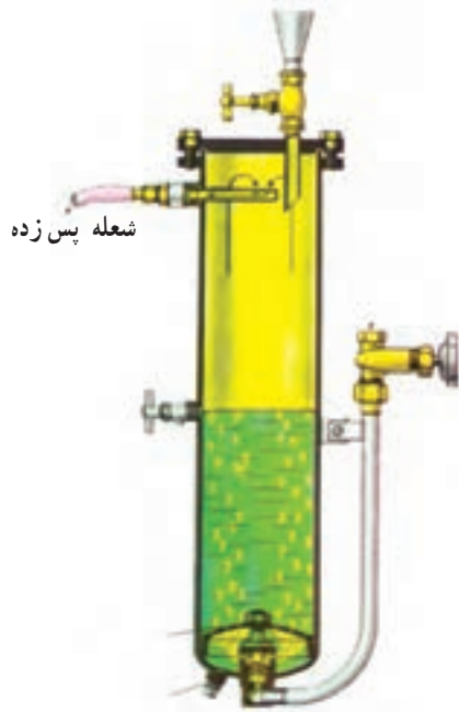
شکل ۲-۴۲- هنگامی که شعله پس می‌زند
