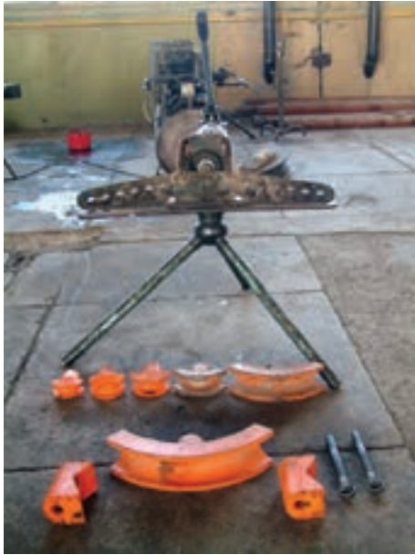
شکل ۱۳-۳- اجزای خم کن هیدرولیکی
