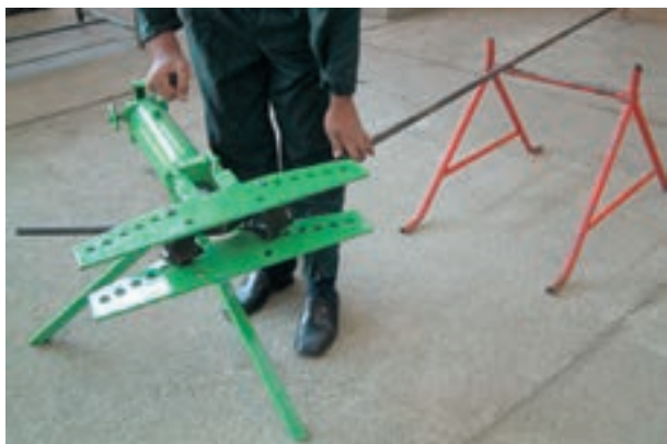
شکل ۳-۴۲- استفاده از خرک در خم کاری
