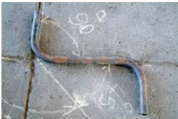
شکل ۳-۴۱- عدم دویدگی لوله‌ی دو خم
