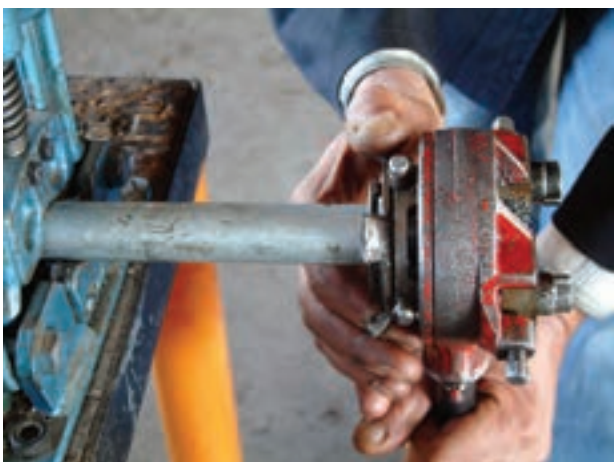
شکل ۴-۳۹- باز کردن فلکهای چهارنظام
