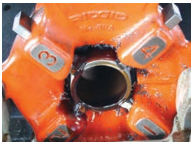
شکل ۴-۹۵- عمل حدیده‌کاری به وسیله حدیده‌ی ماشینی
