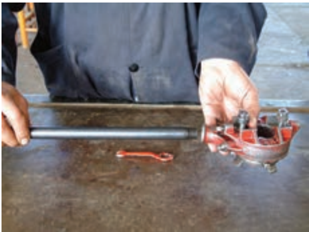
شکل ۴-۲۵- اتصال دسته‌ی حدیده به بدنه‌ی حدیده
