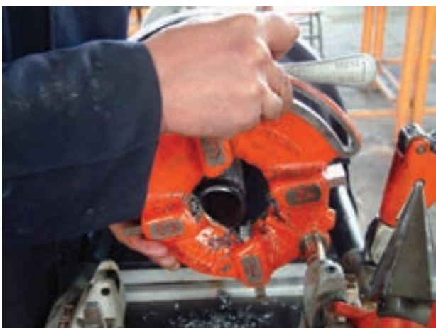
شکل ۴-۹۰- جدا کردن تنه‌ی حدیده از دستگاه
