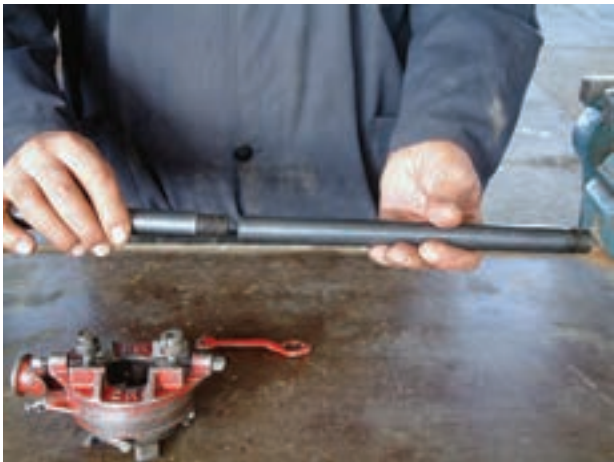
شکل ۴-۲۴- اتصال دسته‌ی دو تکه به یک‌دیگر
