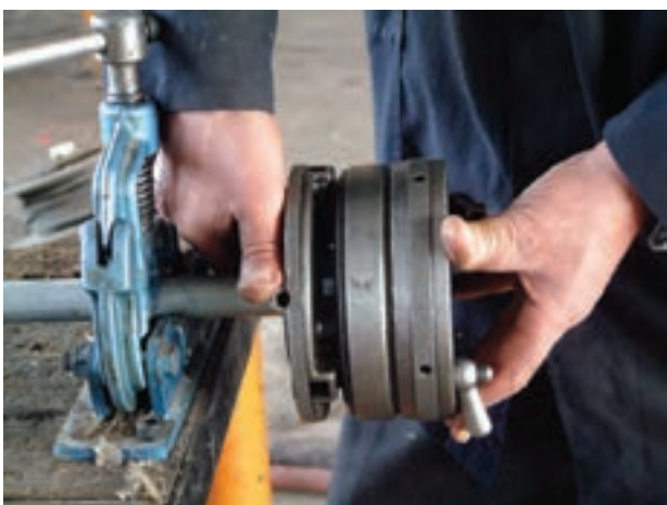
شکل ۴-۶۴- سفت کردن سه نظام حدیده
