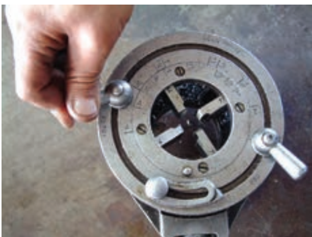
شکل ۴-۶۲- سفت کردن مهره‌های ثابت‌کننده‌ی رینگ متحرک
