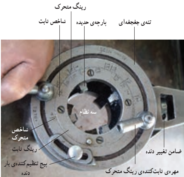
شکل ۴-۵۵- اجزای حدیده‌ی دستی چهار پارچه
