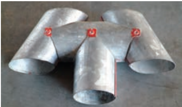
شکل ۴-۱- اتصال چند قطعه به روش پرچ‌کاری
