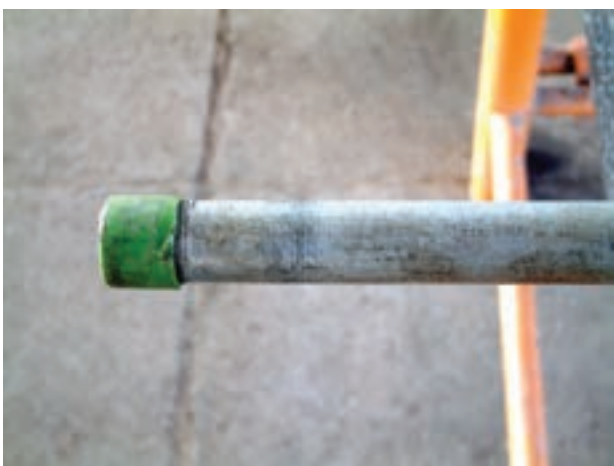
شکل ۱۶-۴ اتصال بوشن پلاستیکی به سردنده‌ی لوله
