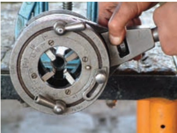
شکل ۴-۵۶- قرار دادن ضامن در حالت F
