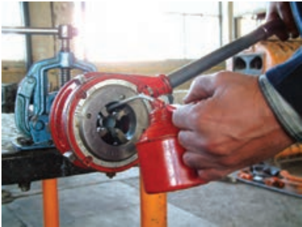
شکل ۱۲۳-۴- استفاده از روغن‌دان در جریان حديد‌کاري
