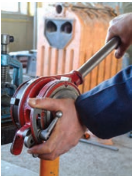
شکل ۴-۱۲۲- عمل درگیر کردن پارچه‌ها با سر لوله
