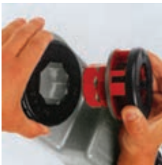
شکل ۴-۱۰۴ - تعویض پارچه‌های حدیده
