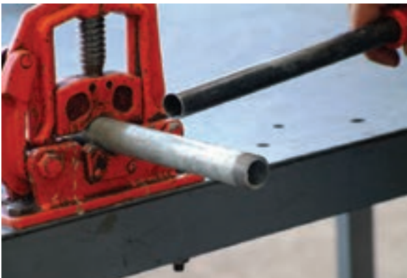
شکل ۴-۱۱۷ جداسازی پلیسه از سر دنده
