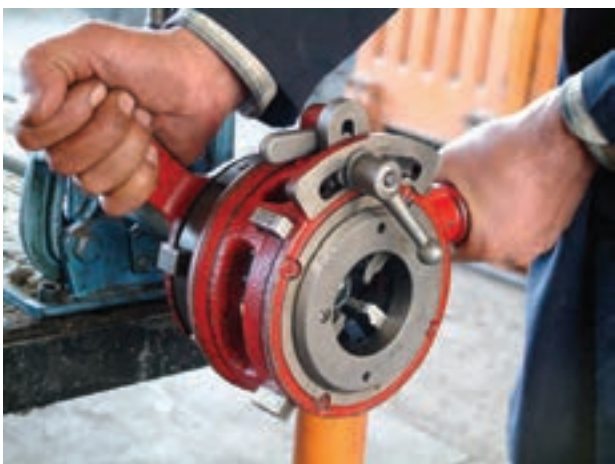
شکل ۴-۱۲۰- بستن اهرم فلکهای چهار نظام
