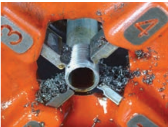
شکل ۴-۱۱۶ طول مناسب دنده
