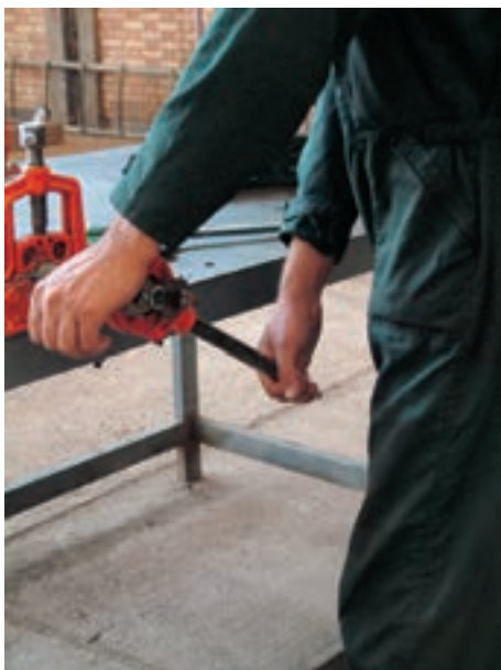
شکل ۴-۱۱۲- حدیده‌ی متناسب با قطر لوله
