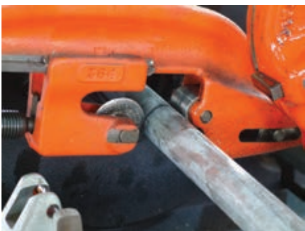
شکل ۴-۱۳۷- بریدن لوله به وسیله ی لوله بُر
