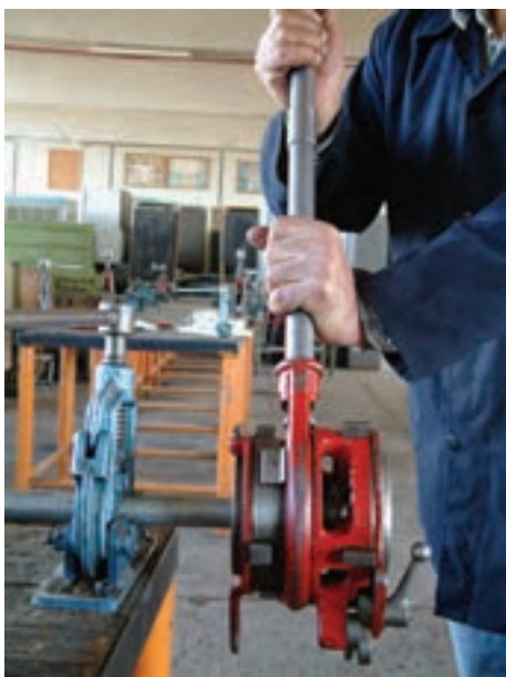
شکل ۱۲۶-۴- باز کردن حدیده از لوله
