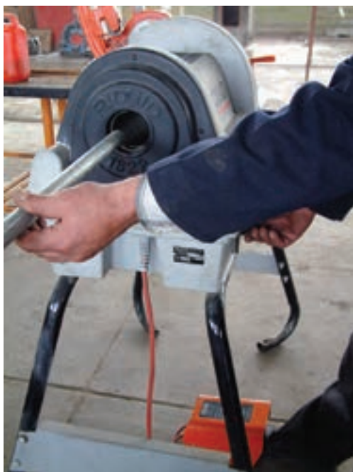
شکل ۱۳۱-۴- قراردادن لوله در حدیده‌ی ماشینی
