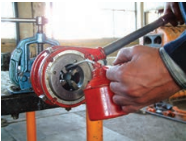
شکل ۴-۱۱۵- استفاده از روغن‌دان در جریان حدیده کاری
