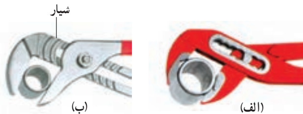
شکل ۷۰-۵- سوراخ‌ها و شیارهای متعدد آچارهای کلاغی
