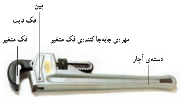
شکل ۵-۶۰- اجزای آچار لوله‌گیر
