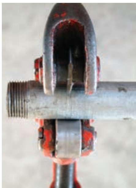
شکل ۹۶-۵- استفاده‌ی غلط از لوله‌بُر با تیغهی شکسته
