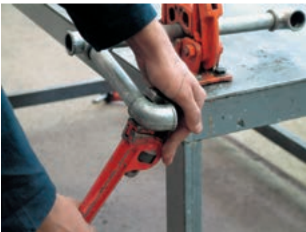
شکل ۱۰۵-۵- روش غلط سفت کردن مدار
