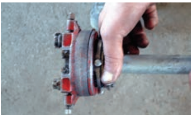
شکل ۱۲۴-۵- باز کردن فلکهای چهار نظام حدیده
