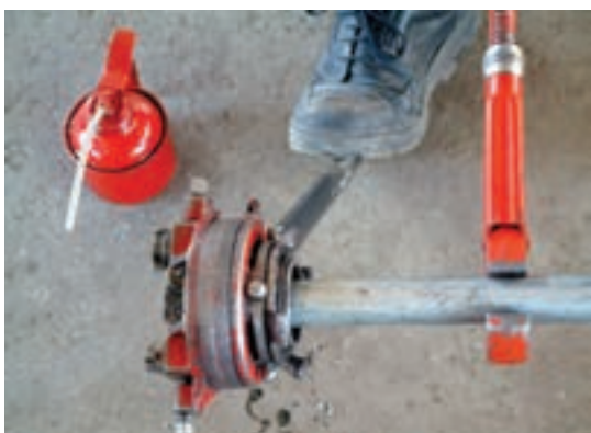
شکل ۱۲۳-۵- عمل باز کردن سردنده از پارچه‌های حدیده
