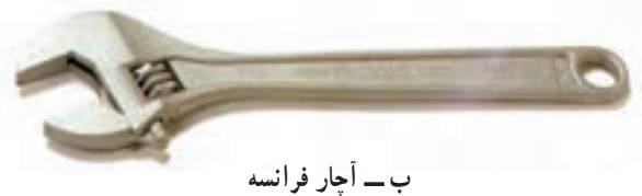
شکل ۵-۷۵- دو نوع آچار قابل تنظیم با فک صاف
