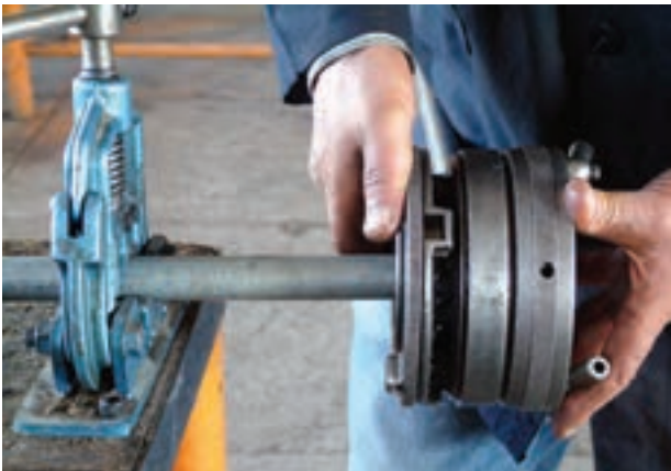
شکل ۱۳۰-۵- حدیده کردن لوله‌ها
