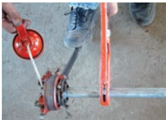
شکل ۱۲۱-۵- استفاده از روغن در جریان حدیده کاری
