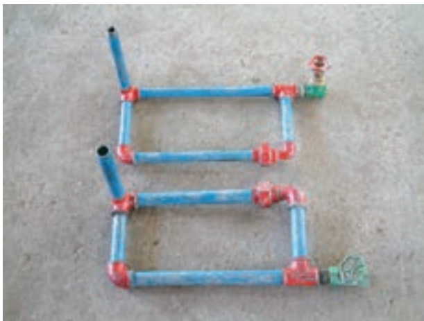
شکل ۵-۱۱۰- مدار بسته لوله‌کشی
