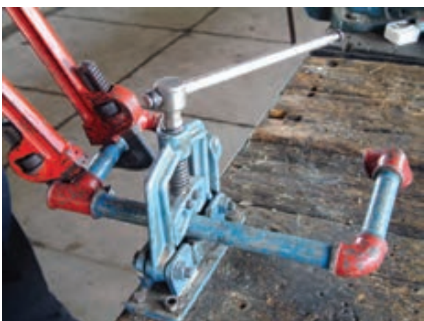
شکل ۵-۱۵۶- بستن ضلع سوم مدار به سه‌راهی
