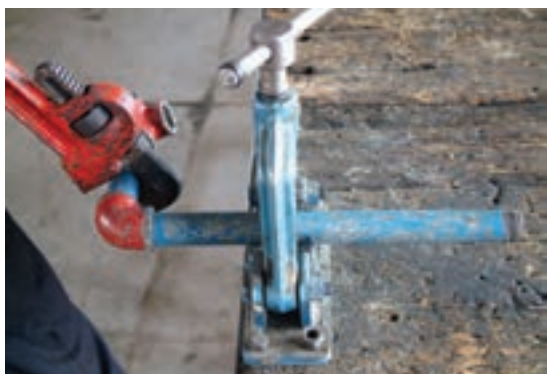
شکل ۱۵۴-۵- بستن لوله‌ی ضلع دوم مدار
