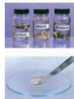
شکل ۴ فلزهای قلیایی را به علت واکنش پذیری زیادی که با آب و هوا دارند، در زیر نفت نگاه می دارند.
