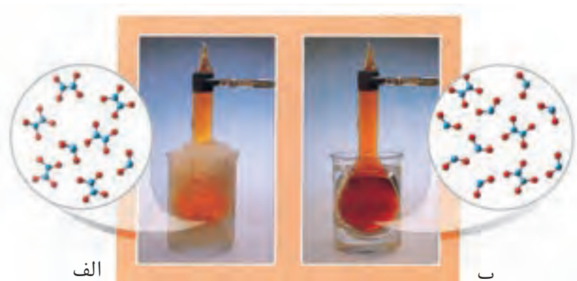
شکل ۷- تعادل میان گازهای \text{NO}_2 و \text{N}_2\text{O}_4 در دو دمای مختلف
