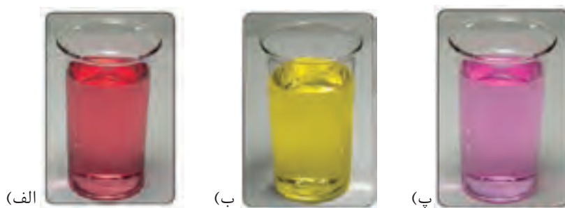
شکل ۱۱- تغییر رنگ شناساگرها در محلول اسیدی و بازی. الف) متیل سرخ در محلول اسیدی، ب) متیل سرخ در محلول بازی، پ) فنول فتالئین در محلول بازی
