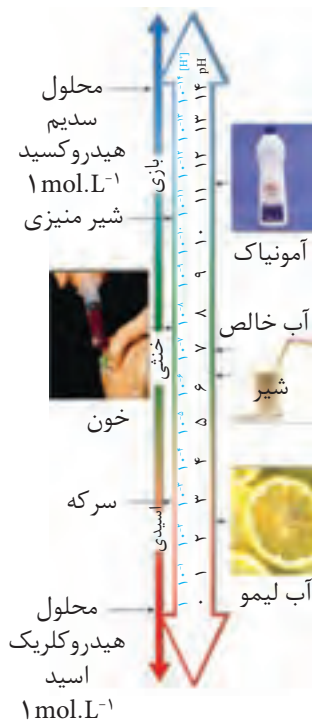
شکل ۷- مقیاس pH و رابطه آن با غلظت یون هیدرونیوم
