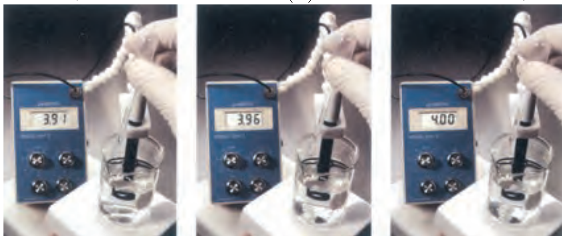
شکل ۱۴- افزودن اندکی اسید قوی و باز قوی به یک محلول بافر
