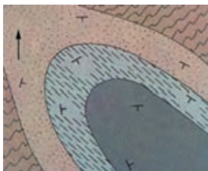
شکل ۱۴-۹- نقشه زمین شناسی یک ناودیس مایل. جهت میل ناودیس به طرف جنوب شرقی است.
