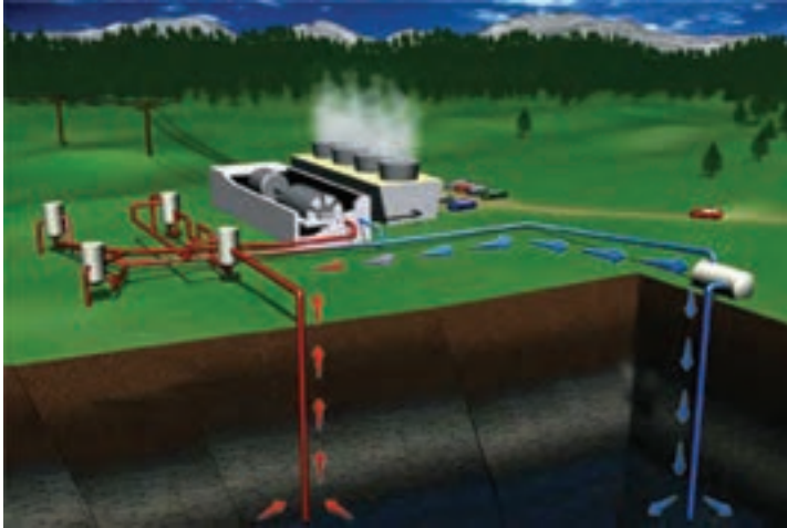
شکل ۱۱-۱۰ طرح چاه و نیروگاه زمین گرمایی
