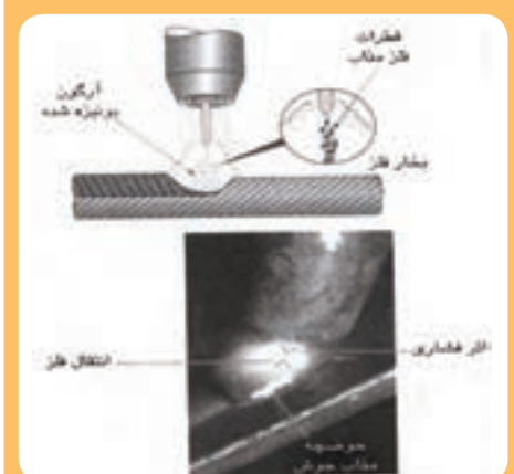
انتقال ذرات مذاب از نوک الکتروود مصرفی به طرف حوضچه مذاب به صورت اسپری
