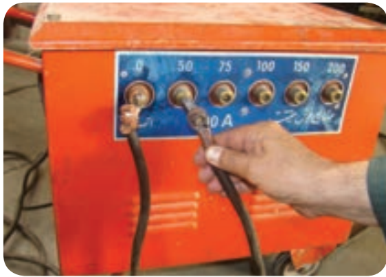
تنظیم آمپر در دستگاه ترانسفورماتور پله‌ای
