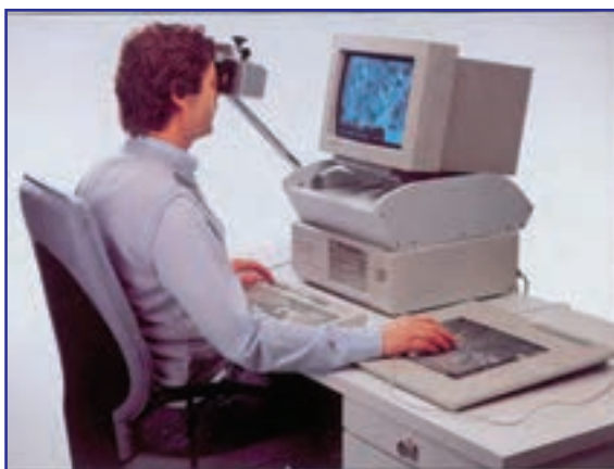
شکل ۷- ترسیم نقشه از روی عکس‌های هوایی به کمک رایانه
