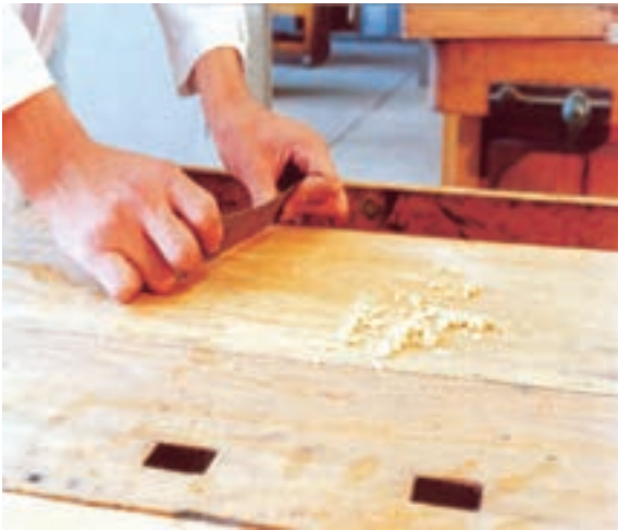
شکل ۱۷-۲- تمیز کردن سطح میز کار با لیسسه.
