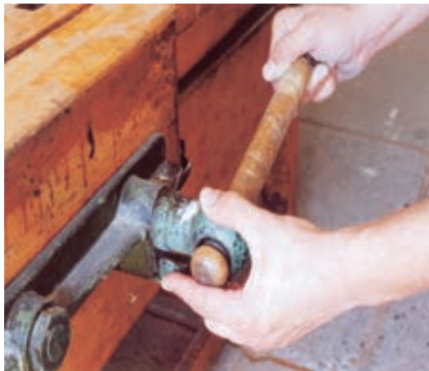
شکل ۲-۱۸- ضامن باز و بسته کردن آزاد گیره.
