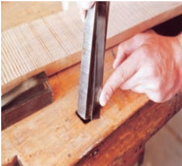
شکل ۲-۲۰- نمونه‌ی استقرار آهن نگهدارنده‌ی قطعه کار.
