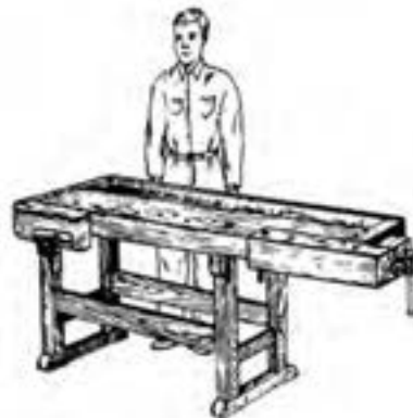
شکل ۲-۲- ارتفاع استاندارد میز کار.
