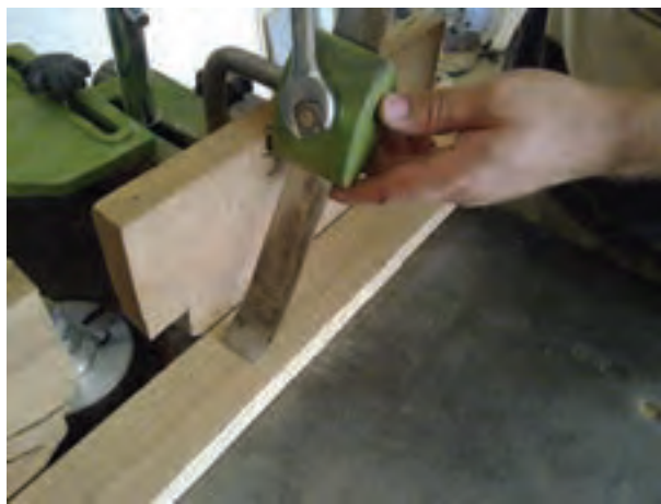
شکل ۲-۲۹- بستن حفاظ فیزی
