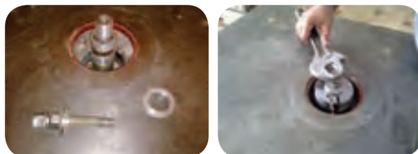
شکل ۲۸-۲- تنظیم کردن تویی در دستگاه فرز
