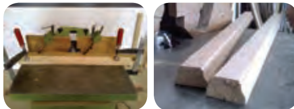
شکل ۲-۳۰- چوب ابزار خورده، ابزار زدن قطعه کار
