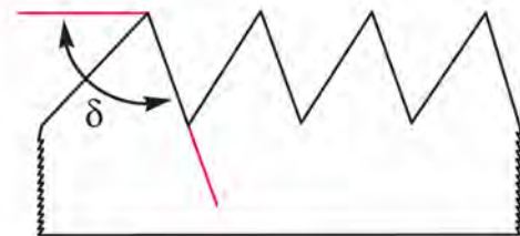
شکل ۵-۳۳- زاویه‌ی برش \delta بیشتر از ۹۰ درجه.
