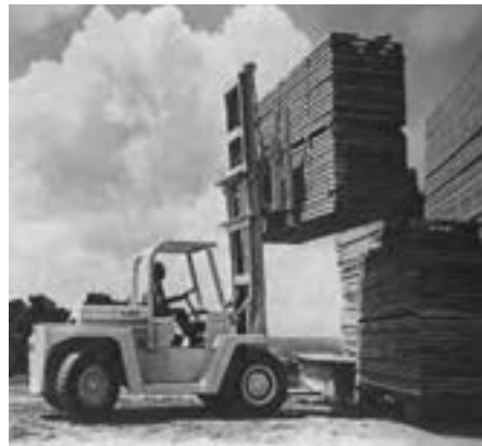
شکل ۳-۳۹- جابجایی دسته‌بندی به وسیله‌ی لیفت‌تراک.
