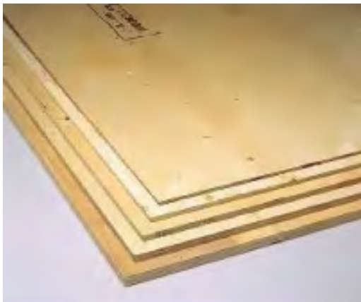
شکل ۳-۱۴۷- تخته فرده چوب با روکش طبیعی.
