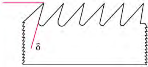
شکل ۵-۳۴- زاویه‌ی برش، کمتر از ۹۰ درجه.
