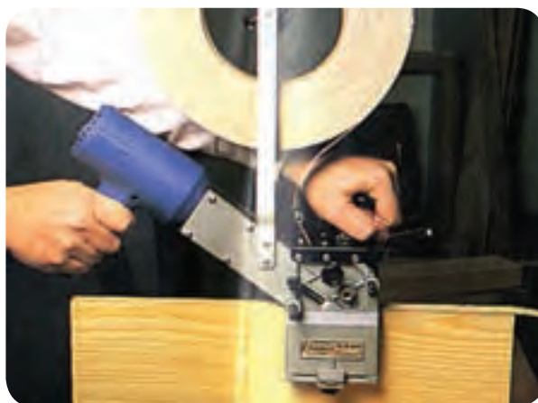
شکل ۴-۱۹ - نحوه نوار کردن با سشوار
