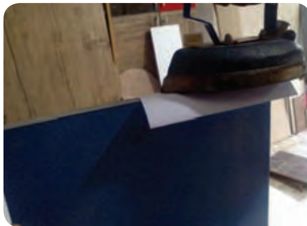
شکل ۴-۴۸- حرکت اتو در روی قطعه کار
