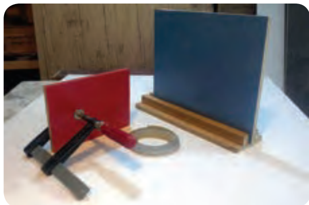
شکل ۴-۴۵- نحوه استقرار قطعه کار
