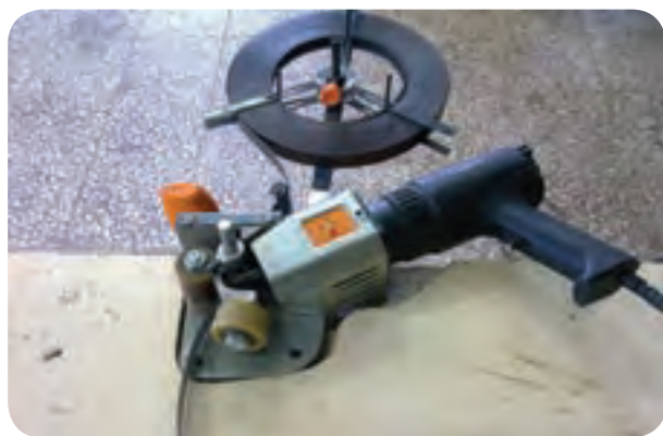
شکل ۴-۲۱ - نحوه استقرار سشوار روی میز
