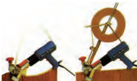
شکل ۴-۲۰ - نحوه نوار کردن کارهای مستقیم و قوسی
