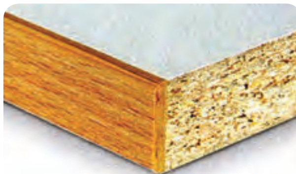
شکل ۴-۲- لبه نئوپان‌ها فاقد زیبایی و صافی هستند.
