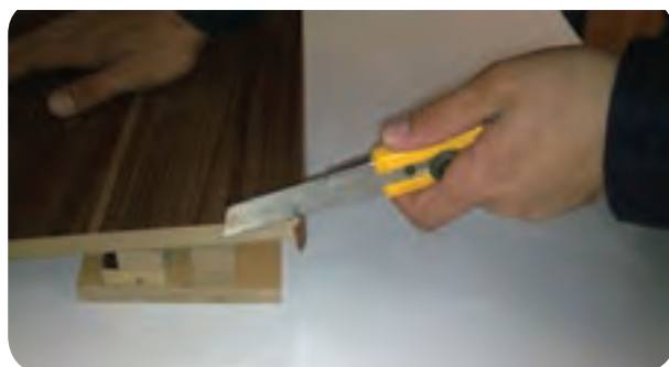
شکل ۲۸-۴ - قطع کردن سر و ته نوار با کاتر
