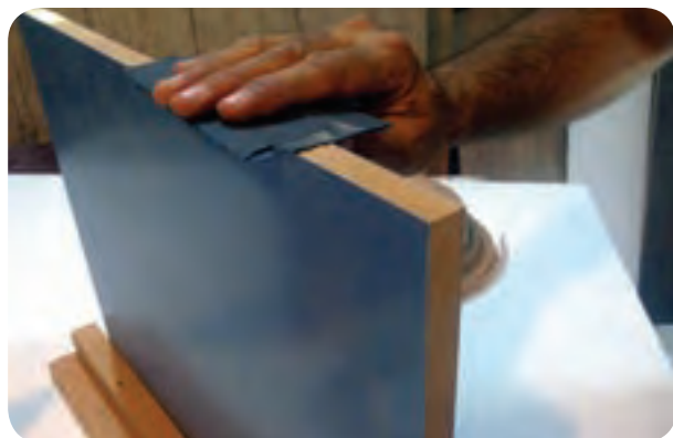
شکل ۴-۴۶- سنباده زدن نوار کار
