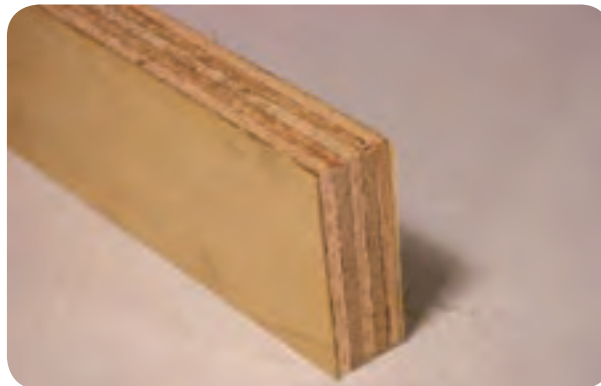
شکل ۴-۱- تخته‌های چند لایه به صورت لایه لایه و به طور کلی، ناصاف اند.
