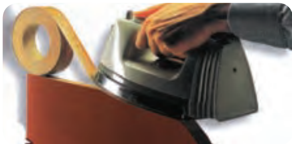
شکل ۴-۱۶ - نوار کردن لبه‌های قوس‌دار توسط اتو
