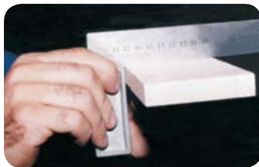
شکل ۶-۷۴. آزمایش صمت رنده‌کاری با گونیا
