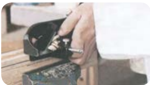
شکل ۶-۷۸. به کارگیری رنده بغل قابل تنظیم.
