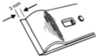
شکل ۶-۷- نمونه‌ی قرار گرفتن پشتی (روی تیغه).
