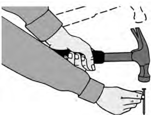
شکل ۳۱-۷. نمونه‌ی گرفتن میخ هنگام کوبیدن.
