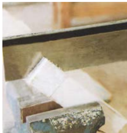
شکل ۵-۵۵- مالت افقی ارّه در پایان برش.
