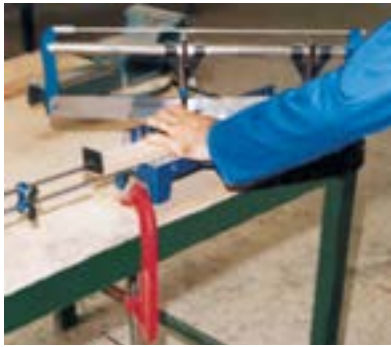
شکل ۵-۶۴- ایجاد برش ۴۵ درجه به وسیله‌ی اژه فارسی‌بُر.
