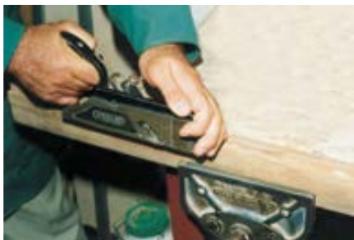
شکل ۶-۷۹. به کارگیری رنده بغل بدون گونیا.
