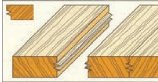
شکل (۳-۱۵۷) اتصال عرضی شانهای ماشینی
