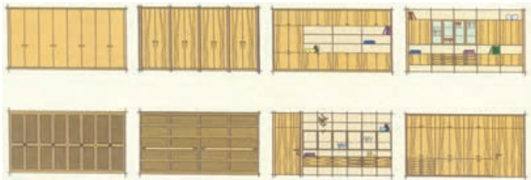
شکل (۳-۶۷) نقشه نماهای انواع کابینت‌های دیواری با هدایت عمودی و افقی
