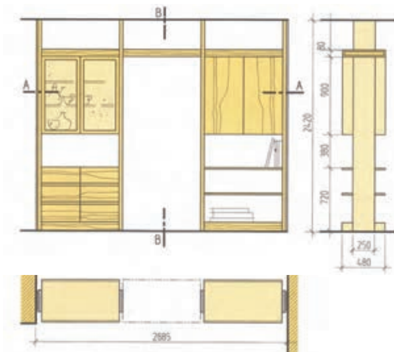
شکل (۳-۹۱) ترسیم نقشه‌ی پلان و نماهای پارتیشن با در برای رفت و آمد به فضای مجاور
