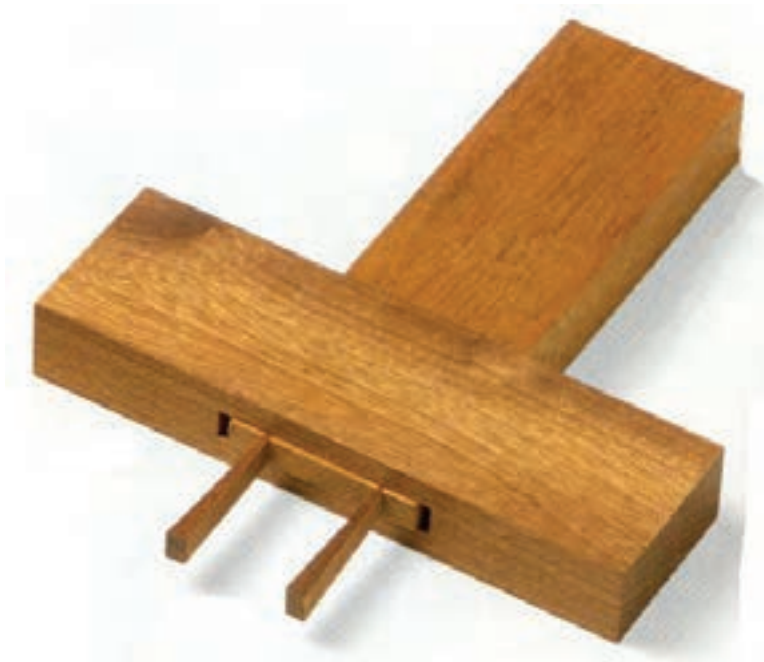
شکل (۳-۱۳۷) تصویر مجسم اتصال میانی کم و زیانه با گوه
