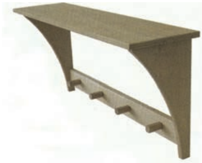
شکل (۳-۱۶۷) تصویر مجسم ایزومتریک جالباسی دیواری
