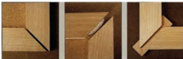
اتصال گوشه‌ای قلیف زبانه جدا دو رو فارسی اتصال گوشه‌ای بیسکوییتی دو رو فارسی اتصال گوشه‌ای دو رو فارسی
