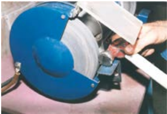
شکل ۷-۴۰- گرفتن پلیسه به وسیله‌ی سنگ سنباده.
