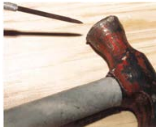
شکل ۷-۳۹- پلیسه‌ی ایجاد شده در سر چکش.
