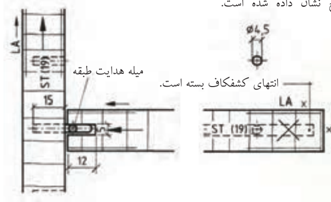
شکل (۴-۵۲) رسم یراق اتصال طبقه کابینت به وسیله زیر سری مفتول زبانه خم در تصویر مجسم و برش پیشانی و برش عمودی کشکاف وار مفتول در انتهای عرض طبقه بسته است.
