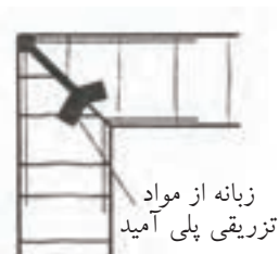
شکل (۴-۶۴) ترسیم علائم اتصال قلیف سراسری تزریقی مواد پلی آمید
