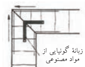
شکل (۴-۶۳) ترسیم علائم اتصال قلیف زبانه سراسری از جنس مواد مصنوعی
