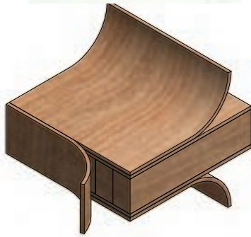
شکل (۴-۱۳) نقشه صفحه STAE به ضخامت ۱۹ میلی‌متر که با احتساب ضخامت روکش‌ها ۲۰ میلی‌متر است.
