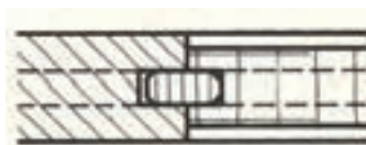
۵- تنکه از جنس مواد مصنوعی کنشکاف زده شده قلیف زبانه جدا
