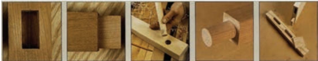
اتصال کُم و زبانه اتصال دوبل سر خود اتصال دوبل جدا اتصال کُم و زبانه جدا شکل (۱-۵) موارد ۱ تا ۵
