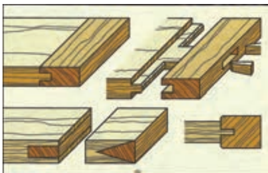
شکل (۵-۱۴) انواع اتصال قلیف با زبانه بلند با گوه زبانه سراسری
