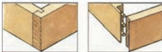
شکل (۵-۴۵) اتصال قلیف دو زبانه مخفی، اتصال قلیف دو زبانه یک رو مخفی
