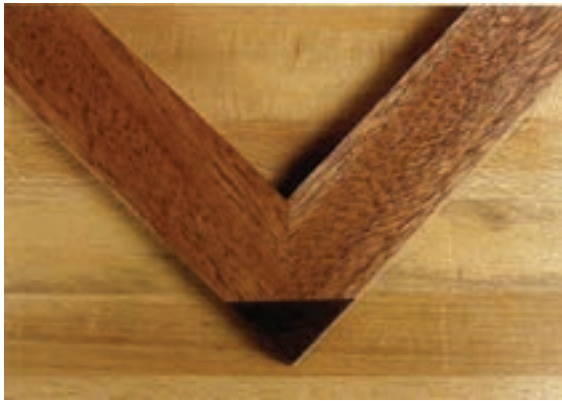
شکل (۵-۳۳) اتصال دور و فارسی با تیکه چسبانی عمود بر درز فارسی برای قاب‌های چوبی
