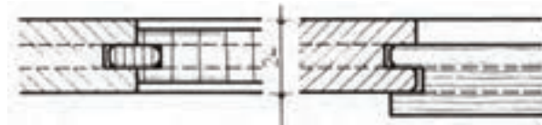
قاب و تنکه به صورت کنشکاف چوبی اتصال قلیف زبانه جدا و قاب تنکه از صفحات مصنوعی با
