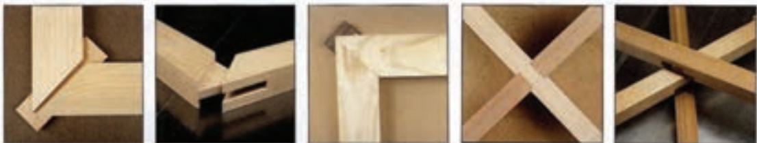
اتصال متقاطع اتصال دور و فارسی با زبانه جدا موازی فارسی اتصال فاق و زبانه دور فارسی اتصال دور و فارسی با زبانه جدا (قلیف) شکل (۴-۵) موارد ۱ تا ۵
