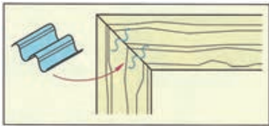
شکل (۵-۳۴) اتصال میخ منگنه زیگزاگی برای قاب‌های چوبی
