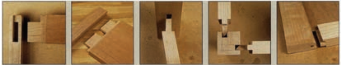
اتصال کُم و زبانه کوله دار اتصال کُم و زبانه دوزبانه اتصال کُم و زبانه کج کُم و زبانه کوله دار قید به پایه مبلمان اتصال کُم و زبانه باز شکل (۲-۵) موارد ۶ تا ۱۰
