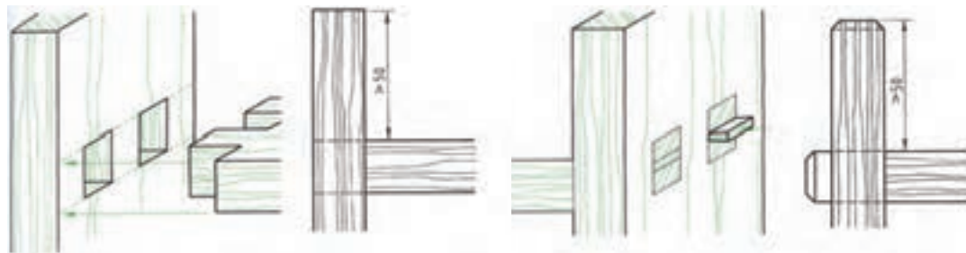
شکل ۵-۷۱: ترسیم اتصال میانی انگشتی در برش پیشانی
