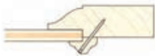
شکل (۵-۳۷) تصویر مجسم اتصال قاب و شیشه پروفیل شده با نمای اتصال و نوع دیگر که با زهوار دو راهه شده شیشه یا تنگه به قاب پروفیل شده محکم شده است.
